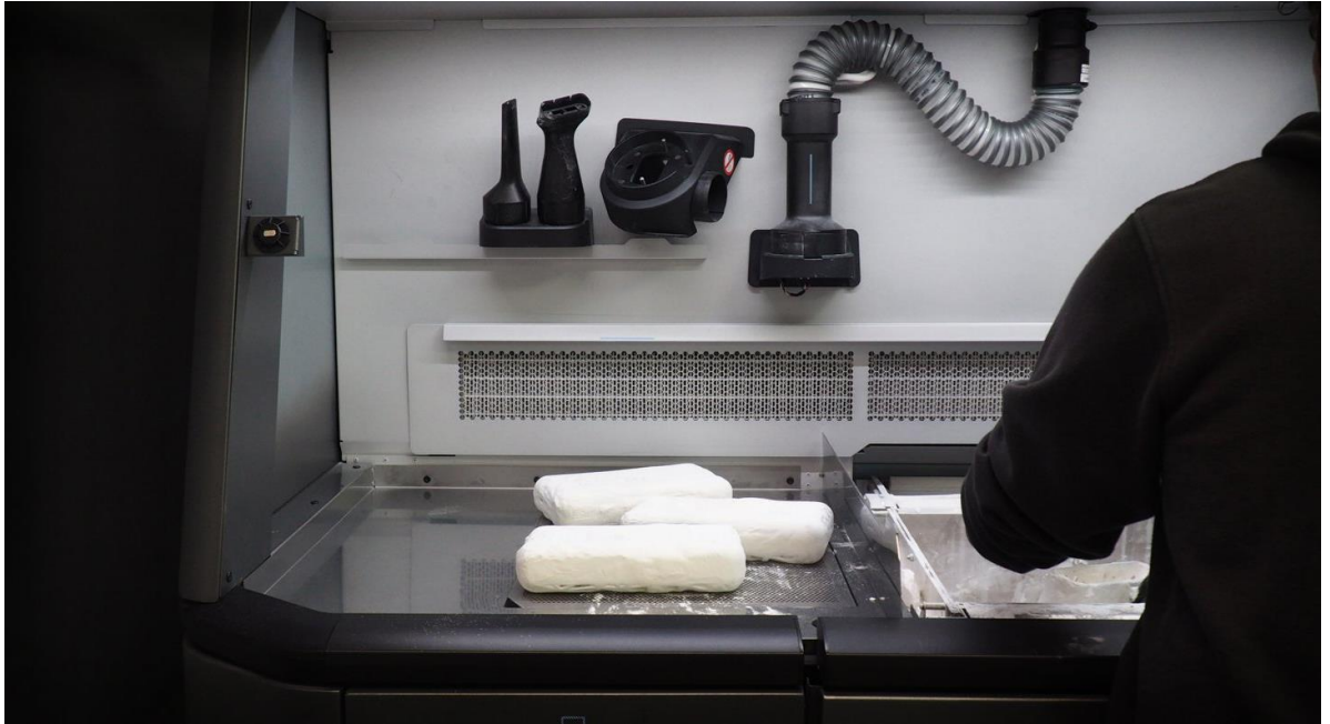
Figura 8. Produzione delle borse di XYZBag, brand torinese di borse FashionTech, realizzate con la tecnologia di stampa 3D Multi Jet Fusion di HP
