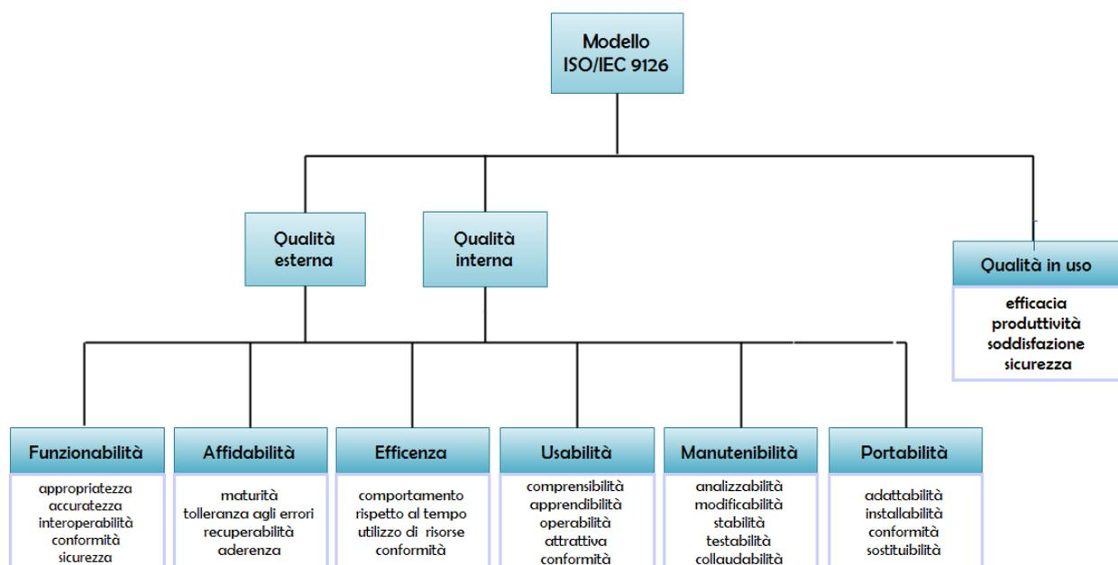
Per la valutazione di ognuna di queste qualità è stata utilizzata una **metrica**: strumenti che forniscono misure quantitative del prodotto e delle sue componenti.
