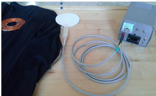
Sistema di ricarica wireless costituito da un generatore ad alta frequenza e da un'antenna circolare da posizionare su poltrone/letti
