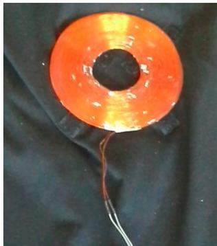
Sul retro della maglietta trova posto un'antenna realizzata mediante 40 spire di filo smaltato, necessaria per l'accoppiamento elettromagnetico con il trasmettitore di potenza.
