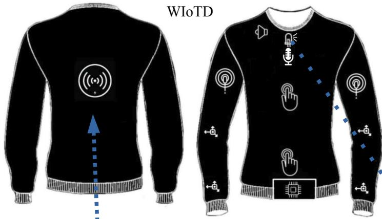
Rilievo di movimenti/suoni, invio di segnali ottici modulati e bluetooth per il comando di apparecchiature, ricezione di messaggi vocali/vibranti/ottici
