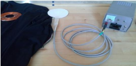
Sistema di ricarica wireless costituito da un generatore ad alta frequenza e da un'antenna circolare da posizionare su poltrone/letti
