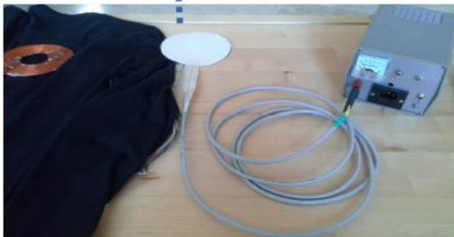
Sistema di ricarica wireless costituito da un generatore ad alta frequenza e da un'antenna circolare da posizionare su poltrone/letti
